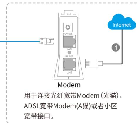
**提示:** 分布式路由器需连接Modem(光猫), 可根据网线和电源线长度来调整分布式路由器位置。建议将分布式路由器置于较开阔或较中心的地方。
